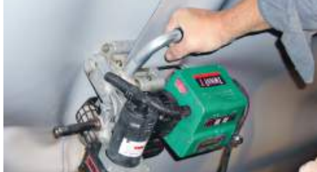
TWINNY T с практичной поперечной рукояткой во время сварки над головой в туннеле
